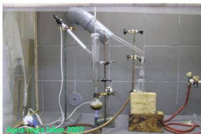
Destillation über heizbare Vigreux-Kolonne
