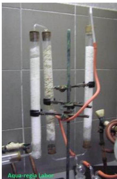
Trocknungsturm von Glasrohren
